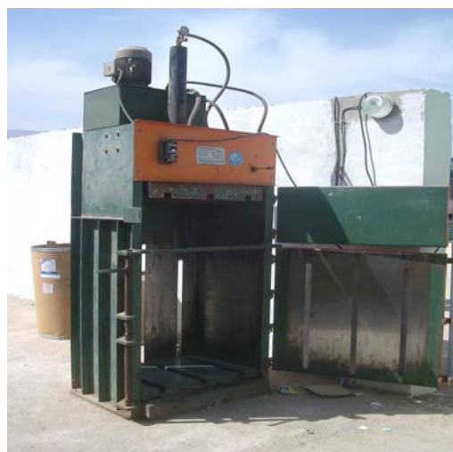
Presse verticale sur le site de la Déchetterie
